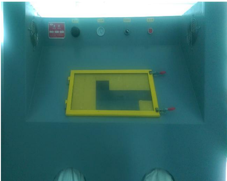
喷砂机：能够调控喷砂力度，带有自动除尘装置。
